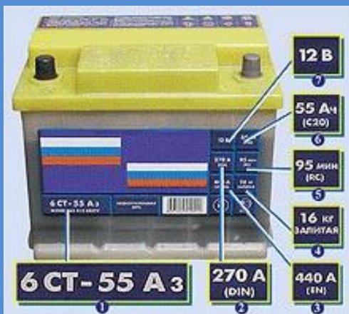
Фото 1. Маркировка российской батареи: 1 – условное обозначение; 2 и 3 – ток холодной прокрутки по DIN и EN; 4 – вес 5 – резервная емкость; 6 – номинальная емкость; 7 – номинальное напряжение
